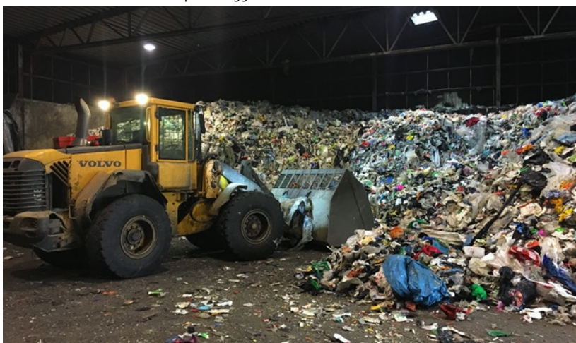
Første step i processen. Her læsses plastaffaldet ind i sorteringsanlægget
