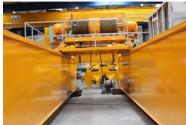
Kran 30, kassedrager samt løbekat
