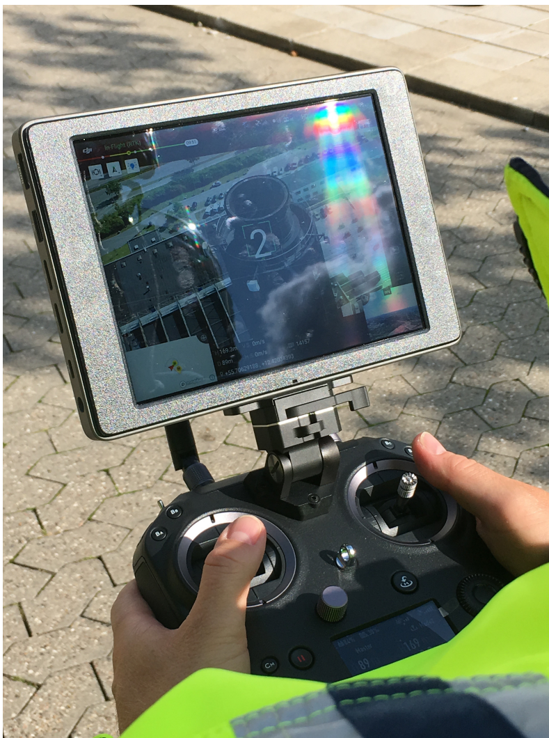
Controlleren hvorfra hhv. drone og kamera styres. På monitoren kan skimtes skorstenens pibespids.
